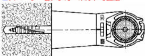
■スペーサーとアンカーボルトで固定
